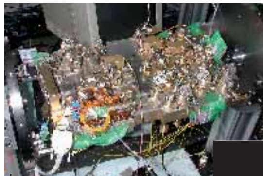
Figure 9 : Le banc optique de Pharaon comporte huit diodes laser stabilisées en fréquence. La lumière nécessaire pour refroidir et manipuler les atomes est envoyée au tube à vide à l'aide de fibres optiques. ©EADS - Sodern
