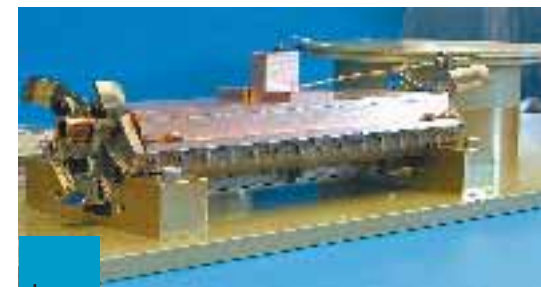
Figure 10 : Le modèle de vol de la cavité d'interrogation de l'horloge Pharaon. Les atomes lents traversent le dispositif à l'intérieur du guide rectangulaire visible sur la gauche de la cavité.
