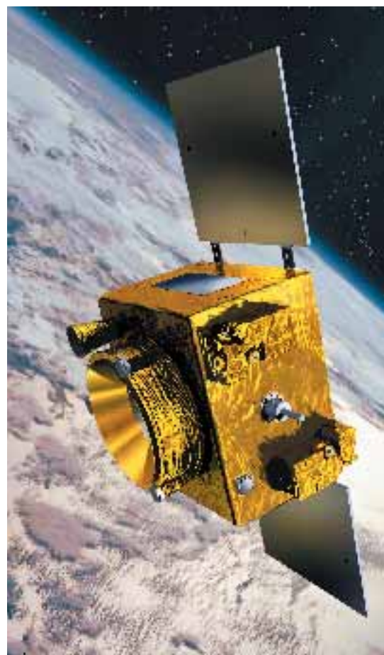
Figure 4 : Le satellite Microscope embarquera en orbite héliosynchrone quatre senseurs inertiels associés deux à deux et sera contrôlé au moyen de quatre ensembles de trois propulseurs électriques.
