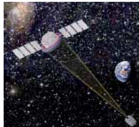
Figure 6a : Max. Une lentille de Laue focalise des rayons gammas sur un satellite situé à 85 m portant des détecteurs Germanium. Max permet principalement l'étude des raies gammas émises par les supernovae.
