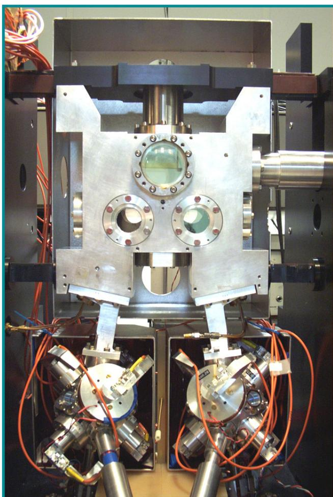
*Gyromètre atomique du SYRTE*
